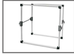
赫姆霍兹线圈 HHS 5215-10 频率范围：DC-100 kHz
